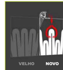
Principalmente em caso de grandes cargas dinâmicas a geometria especial impede uma formação de bloco das dobras, e pressões diferenciais mais baixas são a consequência.
